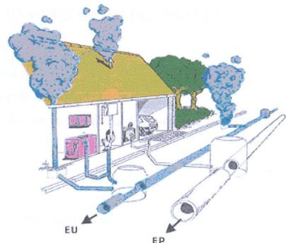
Shéma de principe du test à la fumée
